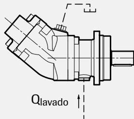
El lavado de la carcasa se puede efectuar con ayuda de una válvula de lavado o directamente desde la línea de retorno. Cuando la presión de retorno es demasiado baja, se compensa con una válvula de contrapresión. La línea del depósito está conectada al punto más alto, como se muestra en la figura.
